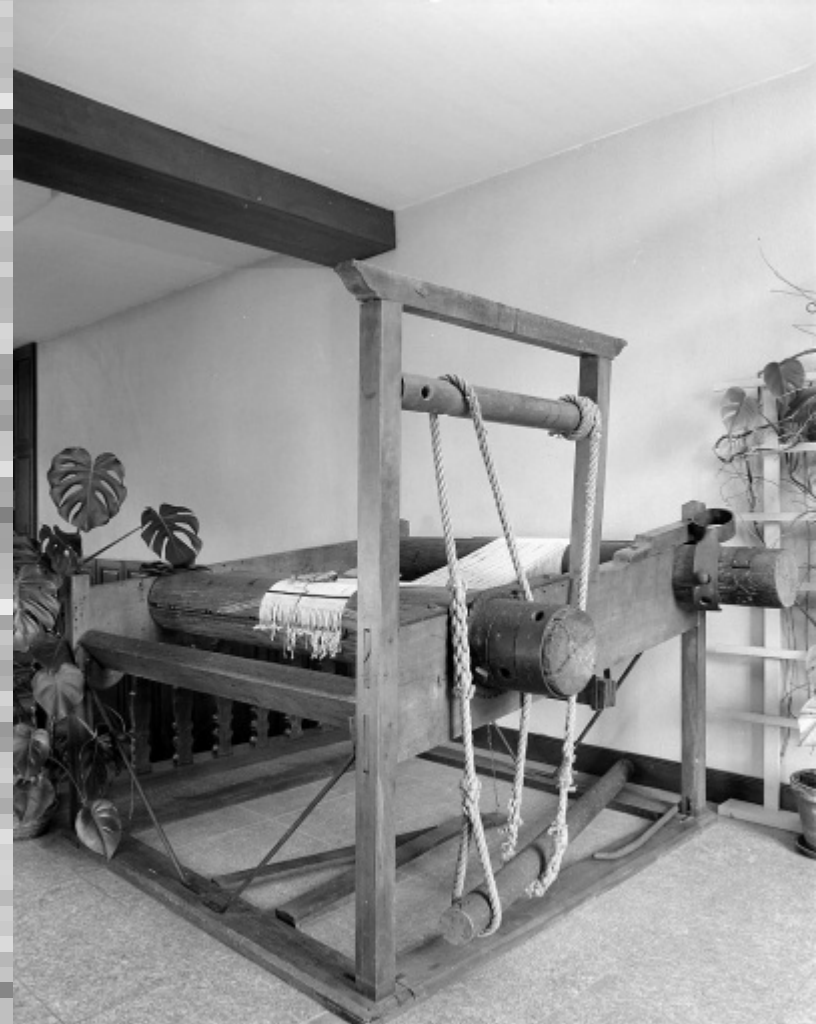
Machine à tisser appelée métier à tisser de basse lisse / Vue du métier dans son ensemble, selon ses dispositions actuelles. Felletin (Limousin) Rivière, P. - © Inventaire général, ADAGP, 2004
